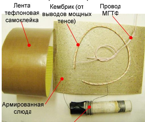
Нихромовый провод DC 3mm
