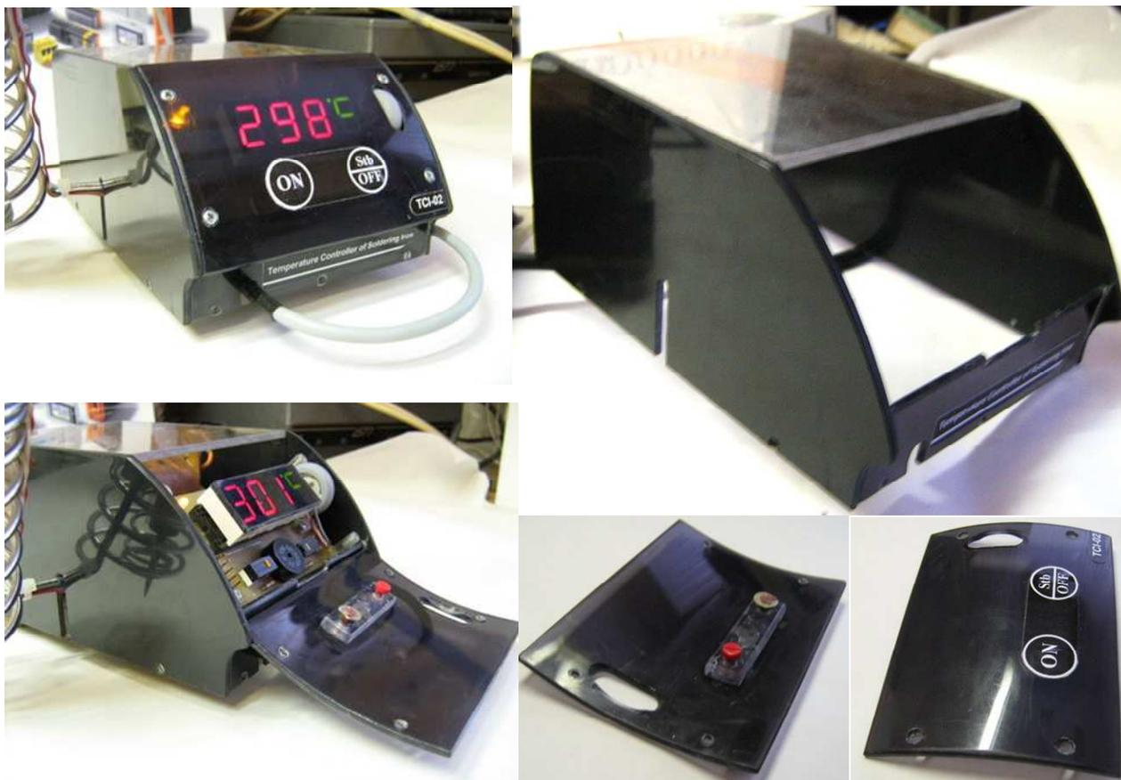
**4.3. Паяльник.** Паяльник переделан из промышленного на 240В. Термопара VK1 изготовлена из термопарного провода хромель-алюмель и встроена в корпус нагревателя. Белые сверхяркие светодиоды HL3-HL5 диаметром 5 мм от ручного фонарика, укреплены в ручке паяльника с помощью клея. Напротив светодиодов в кожухе нагревателя просверлены отверстия, металлические части кожуха не должны касаться светодиодов.
