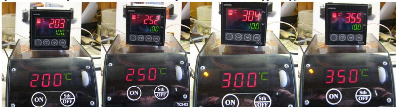
Рис 14. Результат коррекции температурной характеристики устройства.
